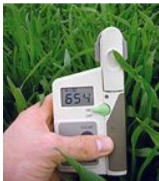
Figura 13 : Modello dello strumento SPAD impiegato per i rilievi
