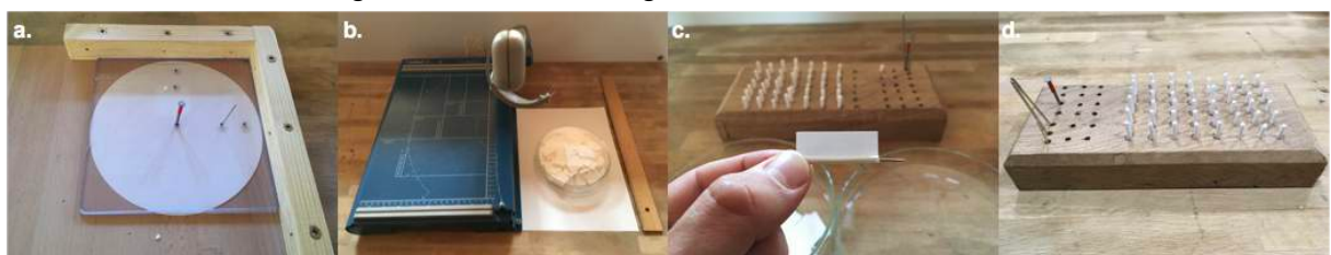
Titre : Préparation et perforation des disques de W1 (a.), découpage sous forme de rectangle (b.), « roulage » (c.) et disposition des mèches (d.)
