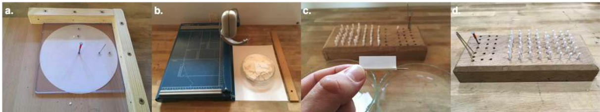
Titre : Préparation et perforation des disques de W1 (a.), découpage sous forme de rectangle (b.), « roulage » (c.) et disposition des mèches (d.)
