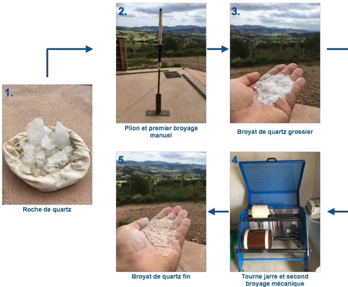
Titre : Étapes du broyage du quartz pour l'élaboration de la préparation silice de corne 501
