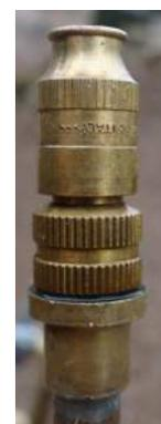
Figure 36 : Buse réglable desserrée (source : L. Thouret)
