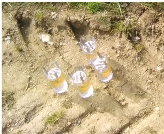
*Figure 6: Verres et tamis utilisés pour le slake test*
