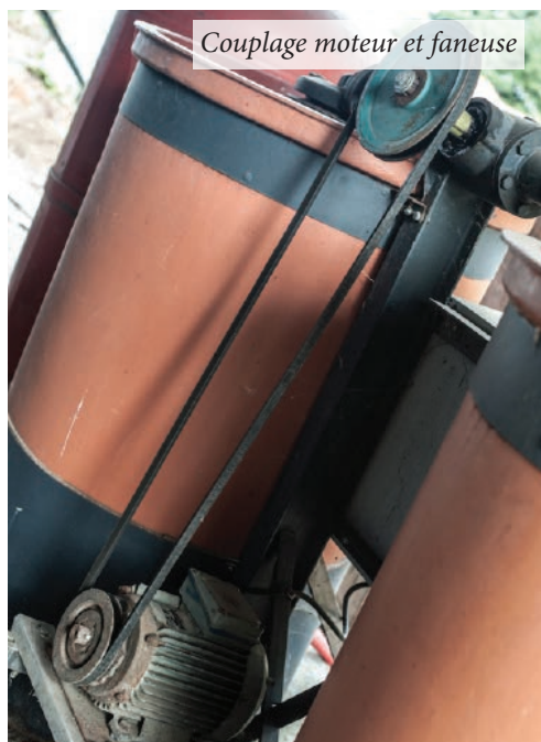
Tension du support moteur et de la courroie
