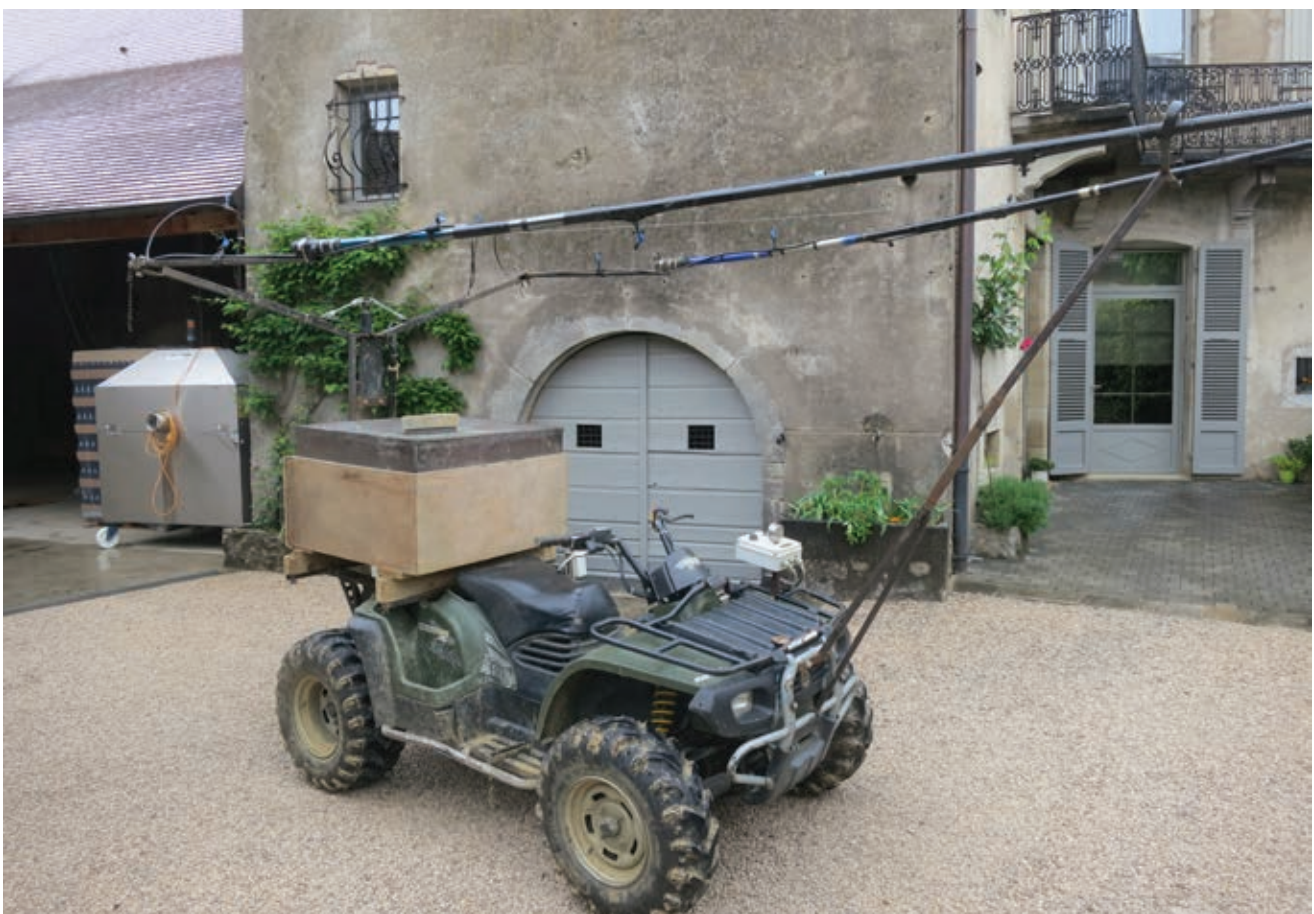
Vue globale du pulvérisateur monté sur quad
