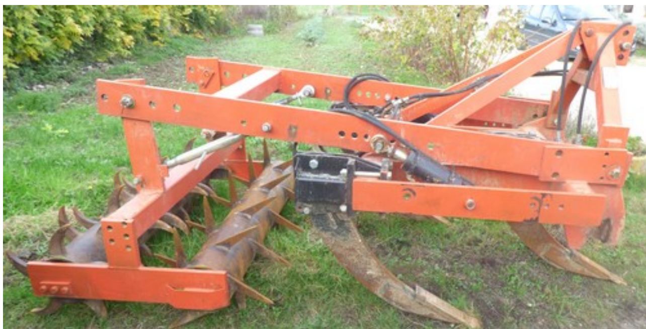
Outil auto construit en 2015 par Aurélien Prouillac, avec rouleau équipé de dents type prairie.
